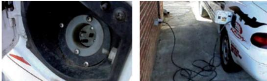
3. Recargas mediante el sistema de carga Magma.
